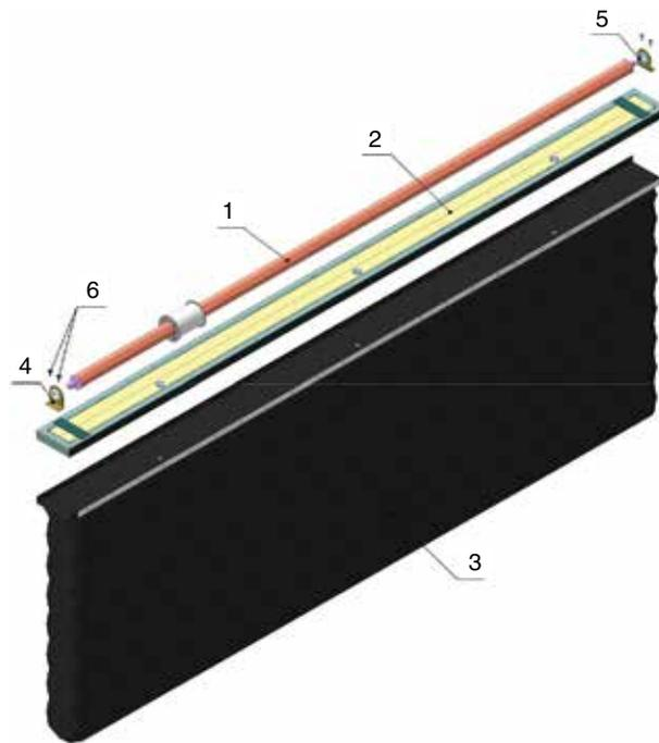
**БАЛКИ ГЕРМЕТИЗАТОРОВ С ПОДУШКОЙ 1200 ММ**
